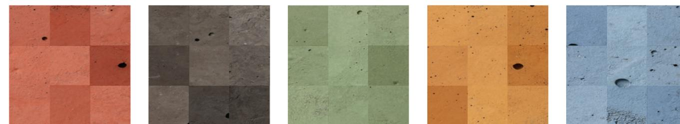
Tendo o betão características heterogéneas devido à sua origem natural e sendo o seu acabamento influenciado pelo método construtivo e condições ambientais, recomenda-se a realização de um protótipo em obra, com o objetivo de simular o comportamento do betão em condições reais de obra, permitindo experienciar aspetos como cor, textura, tipo de acabamento e métodos de aplicação.
