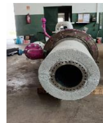
Novo queimador instalado na Fábrica Maceira-Liz
